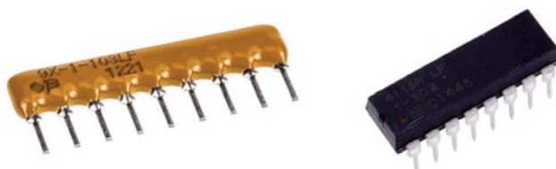
Slika 2.3 Mreže otpornika dolaze u SIL (levo) i DIL (desno) pakovanju
